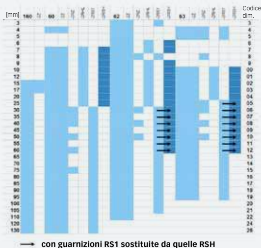
Fig. 3: Estensione della disponibilità di cuscinetti radiali a sfere SKF Explorer con guarnizioni di tenuta RSH. Le frecce indicano i cuscinetti delle serie 62 e 63 con guarnizioni 2RS1 che vengono sostituiti da quelli con guarnizioni 2RSH.
