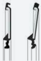
Fig. 8: Influsso del disegno dell'ancoraggio sull'effetto ombrello della tenuta.
