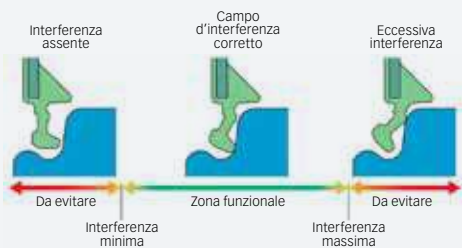
Fig. 7: Influenza delle tolleranze di fabbricazione.
